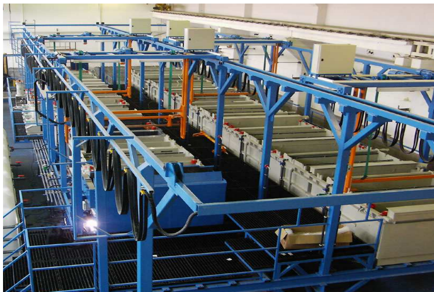
Ryc.4. Poglądowy widok na automatyczną linię galwaniczną do cynkowania 3
