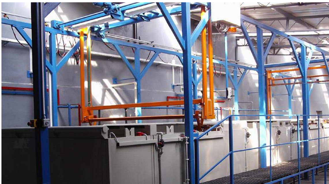
Ryc.6. Widok poglądowy na transportery galwanizacyjne i wanny źródło: http://www.galkor.pl/images/realizacje/reflex_5.jpg
