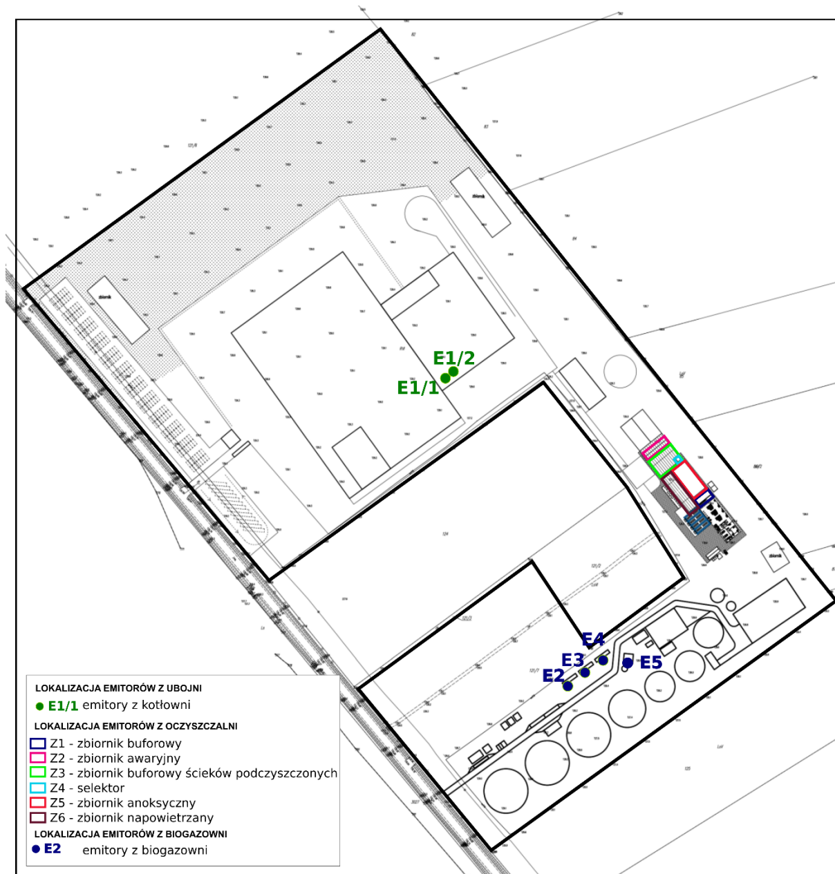
Rysunek 43 Emitory punktowe i powierzchniowe uwzględnione w obliczeniach rozprzestrzeniania się zanieczyszczeń w powietrzu
